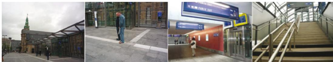
**Fotos 7 – 10:** Auf dem Bahnhof: Blindenleitstreifen an Bahnsteigen, Aufzüge zu allen Gleisen, doppelzügige Handläufe und taktile Markierungen an den Stufen sorgen für Barrierefreiheit. (© Isabella Tiziana Steffan, 2013)
